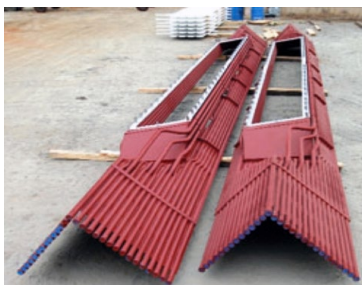
Esquina de Quemadores Tangenciales
